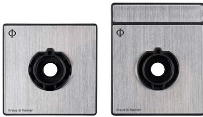
Il existe pour chaque taille de commutateur des plastrons carrés ou rectangulaires. Les plastrons se composent d'un support et d'un cadran indiquant la position des appareils protégé à l'arrière par un film pressé à chaud. Le support de plastron est un élément important du commutateur car il sert également de guide à la manette. Dans le cas où l'on ne souhaite pas de plastron, il est recommandé d'utiliser la plaque T100-04.
